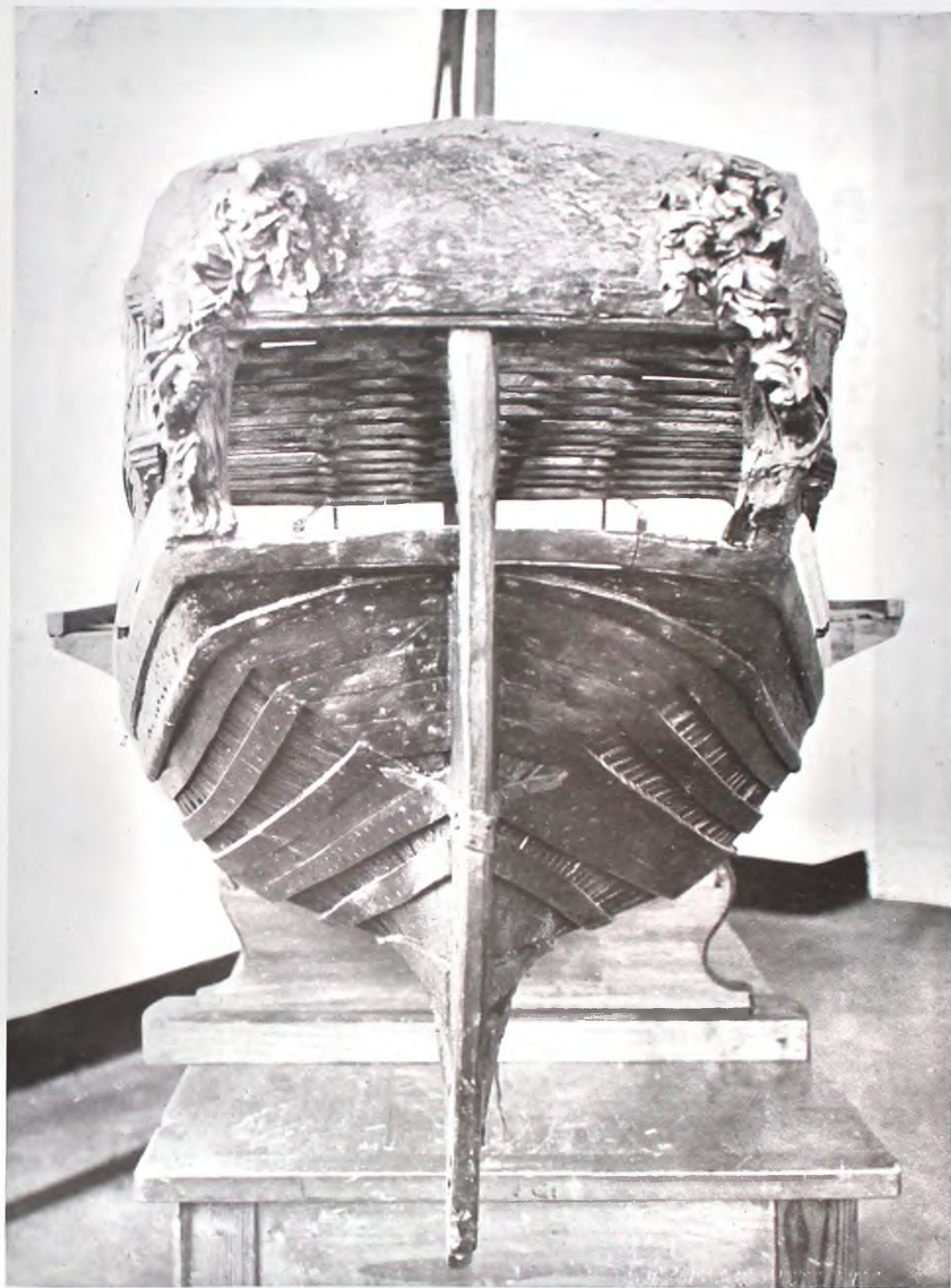
Tav. 4. - Poppa della galea della Tav. 2, con eleganti statue lignee ai due lati. Il timone essendo a squadra con la ruota di poppa è poco visibile. (Genova, Gabinetto fotografico municipale).
